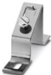
Угловой зажим с винтами М6, служит в качестве упора, закрепляет монтажную рейку в наклонном положении (под углом 30°), высота: 46 мм
