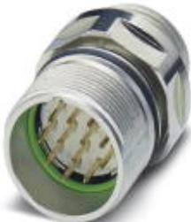
Приборный соединитель, передняя часть стенки, прямой, экранирован.: есть, для стандартной блокировки и SPEEDCON, M23, Полосов: 17, тип контактов: Штифт, Обжим, Осевое уплотнение, Центральное крепление M20 x 1,5, возможность позиционирования при помощи контргайки
