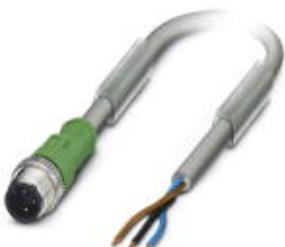
Кабель для датчика / исполнительного элемента, 3-полюсн., PUR без галогенов, стойкий к воздействию искр при сварке, повышенная гибкость, серый RAL 7001, Штекеры прямое M12, А-кодирование, к свободный конец, длина кабеля: 3 м, для использования на роботах и тяговых цепях
