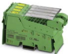
Inline, Клемма аналогового вывода, Аналоговые выходы: 2, 0 В ... 10 В, 0 мА ... 20 мА, 4 мА ... 20 мА, способ подключения: 2-проводная схема, скорость передачи данных в локальной шине: 500 кбит/с, степень защиты: IP20, включая штекеры Inline и поля для маркировки
