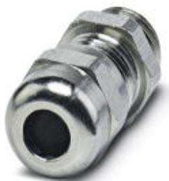
Кабельный ввод, материал резьбового соединения: латунь, никелированный, наружный диаметр кабеля 4 мм ... 6,5 мм, экранировка: есть, резьба соединительной части: M12 x 1,5, цвет: серебристый, с уплотнительным кольцом
