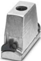
HEAVYCON ADVANCE, сальниковый корпус B24, с байонетным фиксатором (внутренний шестигранник) из высококачественной стали, стойкий к морской воде алюминий, высота 100 мм, с резьбой 1x M40, прямой кабельный отвод, без поверхности; проводящее уплотнение (свойства ЭМС)
