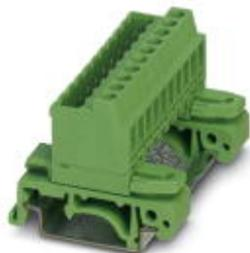
Штекер для установки на монтажную рейку, номинальный ток: 12 А, расчетное напряжение (III/2): 320 В, полюсов: 10, размер шага: 5,08 мм, тип подключения: Винтовой зажим с натяжной гильзой, цвет: зеленый, поверхность контакта: олово, монтаж: Монтажная рейка
