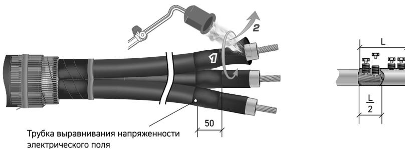
Трубка выравнивания напряженности электрического поля
