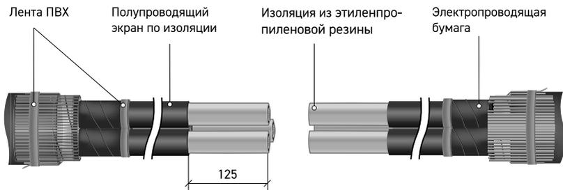
**4.1** Специальным инструментом (роликовым ножом) удалить слой черного полупроводящего экрана по изоляции с каждой жилы обоих концов кабеля на длину 125 мм от среза кабеля. На срезе п/п слоя не допускаются заусенцы, ступеньки и прочие дефекты.
