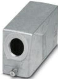
Сальниковый корпус B24, Крепление производится одной защелкой, материал: Из алюминия, методом литья под давлением, стойкий к морской воде, длина кабеля: 1, боковое, высота: 60 мм, кабельный ввод: без, патрубок: Нет, 1x M25, Стандартн.
