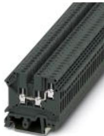
Многовыводная клемма, номинальное напряжение: 400 В, номинальный ток: 24 А, тип подключения: Винтовые зажимы, количество точек подсоединения: 3, сечение: 0,5 мм<sup>2</sup> - 2,5 мм<sup>2</sup>, AWG: 20 - 14, ширина: 5,2 мм, цвет: темно-серая, тип монтажа: NS 35/7,5, NS 35/15, NS 32
