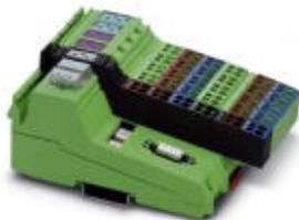
Inline, Block IO, PROFIBUS DP, Гнездо D-SUB-9, Цифровые входы: 16, 24 В DC, способ подключения: 3-проводная схема, Цифровые выходы: 8, 24 В DC, 500 мА, способ подключения: 3-проводная схема, степень защиты: IP20, вкл. штекер Inline и поле
