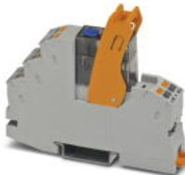
Предустановленный релейный модуль с разъемами push-in, состоящий из: установочного блока (основания), фиксатора реле и реле с силовыми контактами с контрольной кнопкой, встроенным светодиодным индикатором статуса и безынерционным диодом. Исполнение контактов: 1 переключающий контакт. Входное напряжение: 24 В DC
