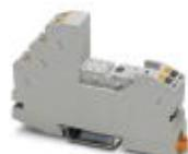
Релейный блок RIF-1..., для миниатюрного силового реле с 1 или 2 переключающими контактами или полупроводникового реле аналогичной конструкции, разъем Push-in, возможность установки входных модулей или модулей подавления помех, для монтажа на NS 35/7,5
