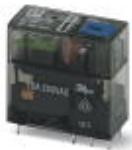
Вставное миниатюрное реле, с силовым контактом, 1 переключающий контакт, кнопка для тестирования, механический индикатор коммутационного положения, статусный светодиод, диод свободного хода, полярность A1+, A2-, входное напряжение 24 В DC
