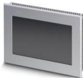
Сенсорная панель с TFT-дисплей 17,8 см / 7"-дисплей (аналогово-резистивные (полиэфир)), 800 x 480 Пиксел (WVGA), 65536 цветов, Arm9™, 200 МГц, 2x USB Host 2.0, 1x Ethernet (10/100 Мбит/с), RJ45, Windows CE 5.0 и прикладное ПО: TSvisRT. (шинная система: MPI)
