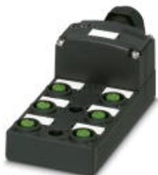
Коробка датчика и исполнительного элемента, применение: Стандартн., тип подключения: Гнездовой разъем M12-SPEEDCON Пластик, количество гнезд: 6, полюсов: 4, механические ключи: А - стандарт, гнездо для платы: один ряд, индикатор состояния: Нет, Универсальный; подключение магистрального кабеля: Пружинные зажимы 180°, экранировка: нет
