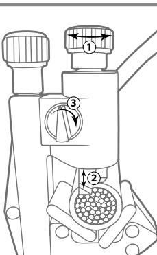
Настройте глубину срезаемой изоляции, вращая регулировочный винт (1): против часовой стрелки — нож (2) опускается, по часовой стрелке — поднимается.
