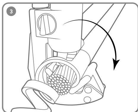
Вращая инструмент за рукоятку вокруг кабеля по спирали, снимите изоляцию на необходимую длину.
