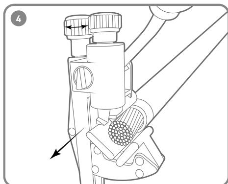
Ослабьте винт регулировки подвижной каретки и аккуратно снимите инструмент с кабеля.
