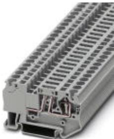
Клемма с размыкателем , номинальное напряжение: 500 В, номинальный ток: 20 А, тип подключения: Пружинный зажим, сечение: 0,08 мм<sup>2</sup> - 6 мм<sup>2</sup>, AWG: 28 - 10, длина: 61,5 мм, ширина: 6,2 мм, цвет: серый, монтаж: NS 35/7,5, NS 35/15, номинальное напряжение: 500 В
