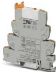
PLC-INTERFACE состоит из основной клеммы PLC-BPT.../21 с зажимом push-in и вставным мини-реле с силовым контактом и ручным управлением, 1 переключающий контакт, входное напряжение 12 В пост. тока
