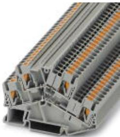
Клеммный блок, со встроенным диодом 1N4007, Макс. ток определяется типом диода. Встроенные диоды 1N 4007, запирающее напряжение: 1300 В, допустимый ток нагрузки при длительной работе: 0,5 А., номинальное напряжение: 500 В, номинальный ток: 20 А, тип подключения: Зажимы Push-in, количество точек подсоединения: 4, сечение: 0,14 мм<sup>2</sup> - 4 мм<sup>2</sup>, AWG: 26 - 12, ширина: 5,2 мм, цвет: серый, тип монтажа: NS 35/7,5, NS 35/15
