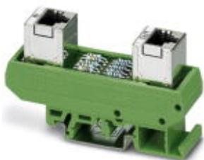
Адаптер для PSR-RSM, аппаратный интерфейс для кодирующего устройства HTL - для согласования сигналов
