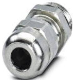
Кабельный ввод, материал резьбового соединения: латунь, никелированный, наружный диаметр кабеля 3 мм ... 6,5 мм, экранировка: есть, резьба соединительной части: Pg7, цвет: серебристый, с уплотнительным кольцом
