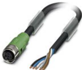
Кабель для датчика / исполнительного элемента, 5-полюсн., PUR, темно-серый RAL 7021, свободный конец, к Гнездо прямое M12 SPEEDCON, A-кодирование, длина кабеля: 15 м
