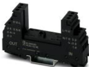
Базовый элемент для защитного штекера PT, со схемой защиты от импульсных перенапряжений сетей электропитания устройств и 2-проводной сигнальной цепи без потенциала земли, для монтажа на NS 35/7,5 и NS35/15, ширина корпуса: 17,5 мм
