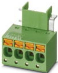
Клеммы для печатной платы, номинальный ток: 20 A, номинальное напряжение: 320 В, размер шага: 5 мм, полюсов: 2, тип подключения: Пружинные зажимы Push-in, монтаж: Пайка волной припоя, направление подключения, проводник/печатная плата: 0 °, цвет: зеленый
