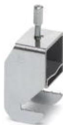
Зажим для экрана, для непосредственного закрепления экрана на проводящей монтажной плате, толщина листа 1 ... 2 мм
