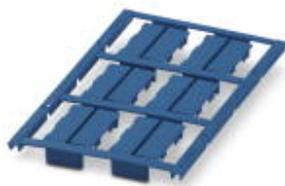
Маркировка для проводов, возможен заказ: в пластинах, синий, надписи в соответствии с требованиями заказчика, тип монтажа: защелкивание, диапазон диаметра кабеля: 5 ... 7,5 мм, размер маркировочного поля: 30 x 8 мм
