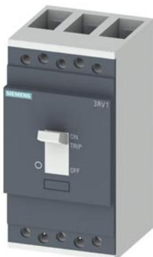
Компактный автоматический выключатель 3RV1 для защиты двигателя Стандартная коммутационная способность Номинальный ток  $I_n = 100\text{ A}$  электронный разъединитель Защита от короткого замыкания регулируется,  $6-13 \times I_n$  Защита от перегрузки, регулируемая  $0,4-1 \times I_n$ , класс срабатывания 10 A-30  $I_{cu} = 120\text{ kA}$  при 400 В 3-полюсный, винтовой зажим включая фазовые перегородки
