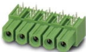
Корпусная часть для печатных плат, номинальный ток: 76 А, расчетное напряжение (III/2): 1000 В, полюсов: 6, размер шага: 10,16 мм, цвет: зеленый, поверхность контакта: Серебро, монтаж: Пайка волной припоя, Направление установки параллельно печатной плате; вилочная часть устанавливается с переворотом под углом 180°.
