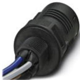
Проходная деталь, Тип подключения QUICKON, полюсов: 4+PE, 1  $\text{мм}^2$  ... 2,5  $\text{мм}^2$ , 690 В, 20 А, черный, без гайки QUICKON, диапазон диаметра кабеля: 6 мм ... 10 мм, монтажная резьба: M25, отдельные жилы (приварен), 2,5  $\text{мм}^2$ , жилы ровно обрезаны, длина кабеля: 0,5 м
