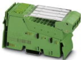
Inline XC, Клемма аналогового ввода, Аналоговые входы: 4, 0 В ... 5 В, -5 В ... 5 В, 0 В ... 10 В, -10 В ... 10 В, 0 мА ... 20 мА, 4 мА ... 20 мА, -20 мА ... 20 мА, способ подключения: 2-, 3-, 4-проводной, скорость передачи данных в локальной шине: 500 кбит/с, Исполнение для тяжелых условий эксплуатации, степень защиты: IP20, включая штекеры Inline и поля для маркировки
