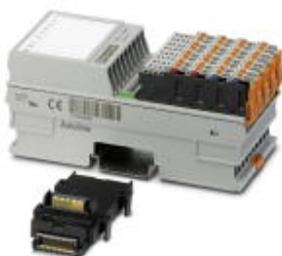
Axioline F XC, Модуль аналогового ввода, Аналоговые входы: 8, 0 В ... 5 В, -5 В ... 5 В, 0 В ... 10 В, -10 В ... 10 В, 0 мА ... 20 мА, 4 мА ... 20 мА, -20 мА ... 20 мА, способ подключения: 2-проводная схема, скорость передачи данных в локальной шине: 100 Мбит/с, Исполнение для тяжелых условий эксплуатации, степень защиты: IP20, с цокольным модулем шины и штекерами Axioline F
