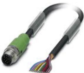
Кабель для датчика / исполнительного элемента, 12-полюсн., PUR без галогенов, черный RAL 9005, Штекеры прямое M12 SPEEDCON, А-кодирование, к свободный конец, длина кабеля: 1,5 м
