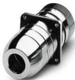
Проходная часть, задняя часть стенки, прямой, экранирован.: есть, Винтовой зажим, M23, Полюсов: 17, тип контактов: Штифт, Обжим, Плоское уплотнение, 4xM3, Толщина стенок, макс.: 2,5 мм, диапазон диаметра кабеля: 4,5 мм ... 5,5 мм
