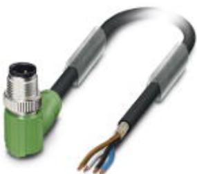
Кабель для датчика / исполнительного элемента, 4-полюсн., PUR без галогенов, темно-серый RAL 7021, экранирован., Штекеры угловой M12, А-кодирование, к свободный конец, длина кабеля: 10 м
