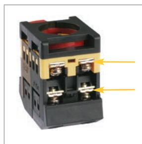
Подключение проводников производят винтовыми зажимами с тарельчатыми шайбами, которые обеспечивают надежную фиксацию проводов.
