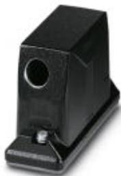
Сальниковый корпус B24, Винтовой зажим, материал: Из алюминия, методом литья под давлением, стойкий к морской воде, длина кабеля: 1, боковое, высота: 93,7 мм, кабельный ввод: без, патрубок: Нет, 1x M25, повышенные требования окружающей среды
