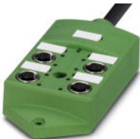
Коробка датчика и исполнительного элемента, применение: Стандартн., тип подключения: Гнездовой разъем M12-SPEEDCON металл, количество гнезд: 4, полюсов: 5, механические ключи: A - стандарт, гнездо для платы: Двойной, индикатор состояния: есть, р-п-р; подключение магистрального кабеля: Жесткое подключение 180°, PUR/PVC, длина кабеля: 5 м, экранировка: нет
