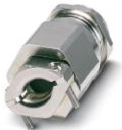
Кабельный ввод, материал резьбового соединения: латунь, никелированный, применение: Стандартн., наружный диаметр кабеля 16 мм ... 28 мм, экранировка: нет, резьба соединительной части: M40 x 1,5, цвет: серебристый, с внешним устройством для разгрузки от натяжения, с уплотнительным кольцом
