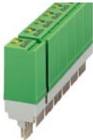
Релейный модуль с мини-реле, материал контактов AgNi+Au: для коммутации нагрузок от низких до высоких, 2 замык. контакта, входное напряжение 120 В AC/DC, световой индикатор, устанавливается на блоки базовых клемм
