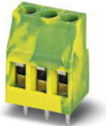
Клеммы для печатной платы, размер шага: 5,08 мм, полюсов: 3, тип подключения: Винтовой зажим с натяжной гильзой, монтаж: Пайка волной припоя, направление подключения, проводник/печатная плата: 0 °, цвет: желто-зеленый
