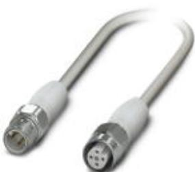
Кабель для датчика / исполнительного элемента, 4-полюсн., PP-EPDM без галогенов, серый RAL 7035, экранирован., Штекеры прямое M12, А-кодирование, к Гнездо прямое M12, А-кодирование, длина кабеля: 1,5 м, Гигиеничный дизайн, с накатанной гайкой из легированной стали
