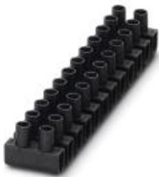
Группа евроклемм из полипропилена, черный, для соединения жестких и гибких проводников с кабельными наконечниками и без них сечением от 0,75 до 6 мм<sup>2</sup>
