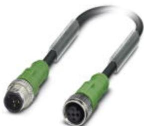
Кабель для датчика / исполнительного элемента, 3-полюсн., PUR без галогенов, темно-серый RAL 7021, Штекеры прямое M12, А-кодирование, к Гнездо прямое M12, А-кодирование, длина кабеля: 10 м, для штекера клапана
