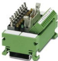
Модуль VARIOFACE с переключателями для проверки кабелей, с разъемом COMBICON (штекерная часть) и разъемом для плоского кабеля, на 8 каналов, устанавливается на монтажную рейку NS 35/7,5
