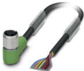
Кабель для датчика / исполнительного элемента, 12-полюсн., ПВХ, черный RAL 9005, свободный конец, к Гнездо угловой M12 SPEEDCON, А-кодирование, длина кабеля: 3 м
