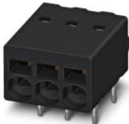
Клеммы для печатной платы, номинальный ток: 6 А, номинальное напряжение: 160 В, размер шага: 2,5 мм, полюсов: 2, тип подключения: Пружинные зажимы Push-in, монтаж: THR пайка, направление подключения, проводник/печатная плата: 0 °, цвет: черный. Набор SAMPLE с 5 артикулами в ленточной секции. Для пайки используйте изделие без маркировки SAMPLE
