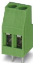
Клеммы для печатной платы, номинальный ток: 24 A, номинальное напряжение: 400 В, размер шага: 5 мм, полюсов: 2, тип подключения: Винтовой зажим с натяжной гильзой, монтаж: Пайка волной припоя, направление подключения, проводник/печатная плата: 0 °, цвет: светло-серый. Возможна установка в ряд модулей с различным количеством полюсов (контактов)!
