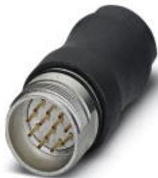
Переходной соединитель, прямой, с пластмассовой оболочкой, экранирован.: есть, Винтовой зажим, M23, Полюсов: 17, тип контактов: Штифт, Обжим, диапазон диаметра кабеля: 5,5 мм ... 6,5 мм
