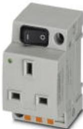
Розетка, Схема расположения контактов тип G, Пружинные зажимы Push-in, для Великобритании и других стран, с расширенной защитой от прикосновения / заслонкой, индикатор, переключатель, зеленый, для монтажа на несущую рейку и в интерфейсе обслуживания или прямого монтажа, 250 В AC, 13 A, -20 °C, 60 °C, BS 1363-1/2
