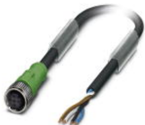
Кабель для датчика / исполнительного элемента, 4-полюсн., PUR, темно-серый RAL 7021, свободный конец, к Гнездо прямое M12, A-кодирование, длина кабеля: 20 м
