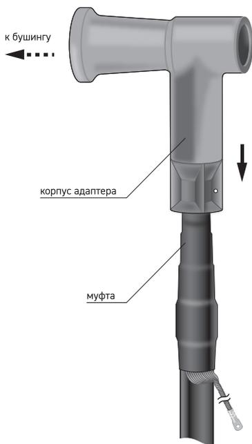
2. Надвинуть корпус адаптера на концевую муфту, так чтобы длинная сторона адаптера была направлена в сторону бушинга. Совместить отверстие контактной шайбы адаптера с отверстием в болтовом наконечнике.
