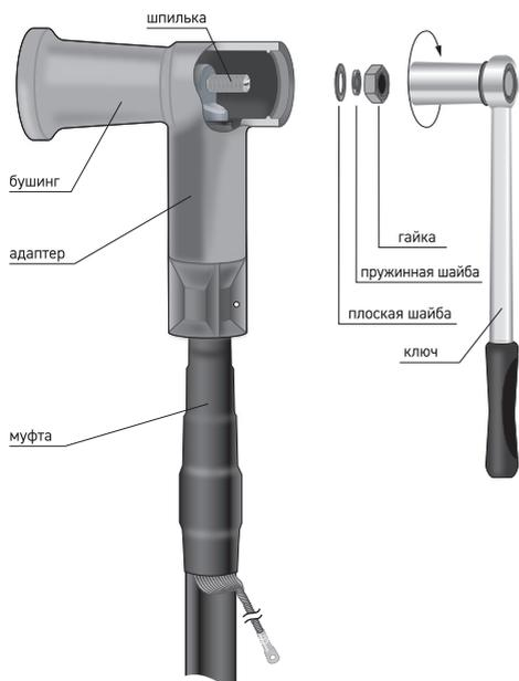
5. Надеть адаптер на бушинг. На шпильку установить шайбы и затянуть гайку с моментом  $60 \pm 3$  Н·м.
