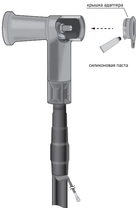
6. Смазать силиконовой пастой профильный выступ крышки адаптера. Установите крышку в корпус адаптера.
