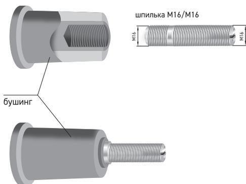
3. Снять заглушку с бушинга, выкрутить старую шпильку (при наличии). Контактную поверхность зачистить до металлического блеска и обезжирить. Ввернуть в бушинг шпильку из комплекта адаптера, стороной с короткой резьбой и затянуть отверткой.
